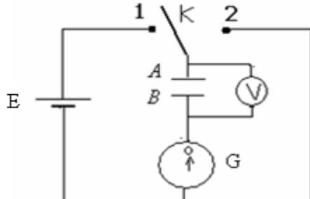
On utilise dans cette expérience un galvanomètre ou un ampèremètre à zéro central.
