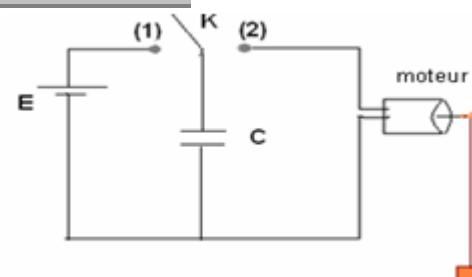
On bascule l'interrupteur K à la position (1) et on le laisse un temps suffisant pour que le condensateur soit chargé puis on le bascule à la position (2).
