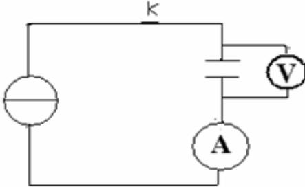
L'ampèremètre indique l'intensité du courant dans le circuit  $I_o = 0,3\mu A$  . On mesure la tension entre les bornes du condensateur après chaque cinq secondes et en utilisant la relation :  $q=I_o \cdot t$  , on détermine la charge q du condensateur à chaque instant.
