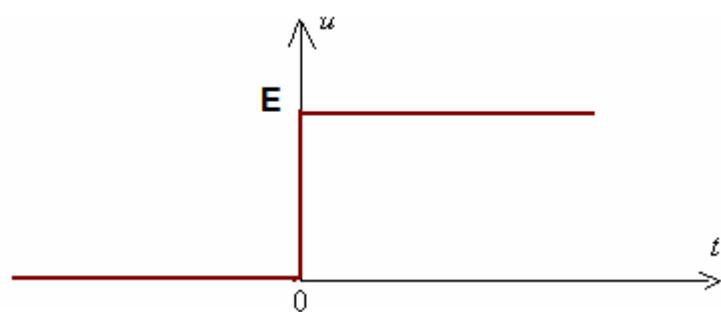
On monte en série un conducteur de résistance R et un condensateur de capacité C et on obtient un dipôle RC puis on le soumis à un échelon de montant de tension à l'aide d'une source de tension continue.
