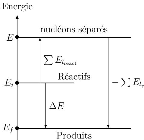
On peut calculer l'énergie  $\Delta E = E_f - E_i$  libérée par une réaction nucléaire par deux méthodes :
