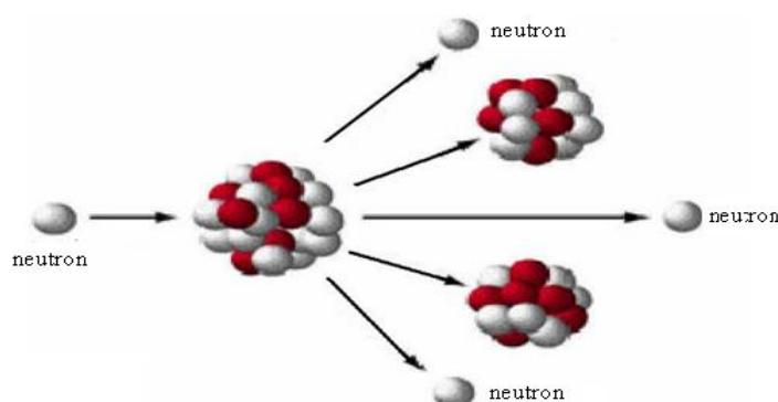
On utilise le neutron dans le bombardement car c'est une particule neutre qui arrive facilement au noyau sans entrer en répulsion avec lui.
