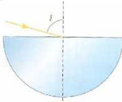
On rappelle la deuxième loi de la réfraction de Descartes: lorsqu'un rayon lumineux passe d'un milieu d'indice  $n_1$  à un milieu d'indice  $n_2$ , les angles d'incidence  $i_1$  et de réfraction  $i_2$  sont liés par la relation:
