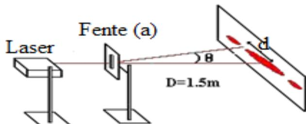
L'écart angulaire  $\theta$ , est l'angle entre le centre de la tache centrale et le centre de la première tache sombre (extinction) ou C'est le demi-diamètre angulaire de la tache centrale.
