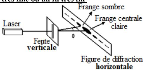
La fente est perpendiculaire à la direction de la figure de diffraction
