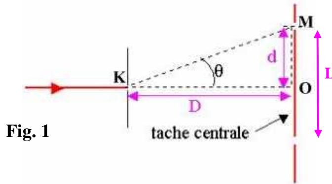
On se place dans le cas de la diffraction d'une lumière monochromatique, de longueur d'onde  $\lambda$  par une fente de largeur  $a$  (ou par un fil d'épaisseur  $a$ )
