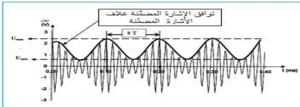
2.2.2- دور التوتر المضمن :  $T = \frac{0,1 \text{ ms}}{8}$  أي:  $8T = 0,1 \text{ ms}$
