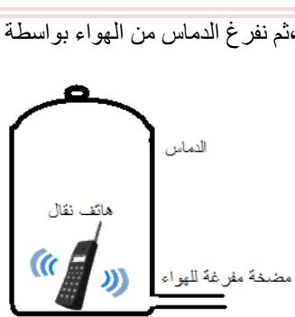
**تجربة 1:** نشغل الهاتف ،ثم نفرغ الدمام من الهواء بواسطة المضخة
