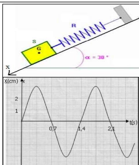
نعتبر نوasa مكوناً من جسم (S) كتلته  $g \text{ m} = 500 \text{ g}$  مرتبطة بنايبض ذي لفات غير متصلة صلابته K وكتلته مهملة. توجد المجموعة فوق مستوى مائل بزاوية  $\alpha = 30^\circ$  حيث ينزلق الجسم بدون احتكاك (الشكل )
