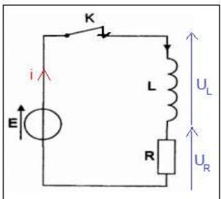
1- دور الوشيعة عند إغلاق قاطع التيار هو تأخير إقامة التيار .
