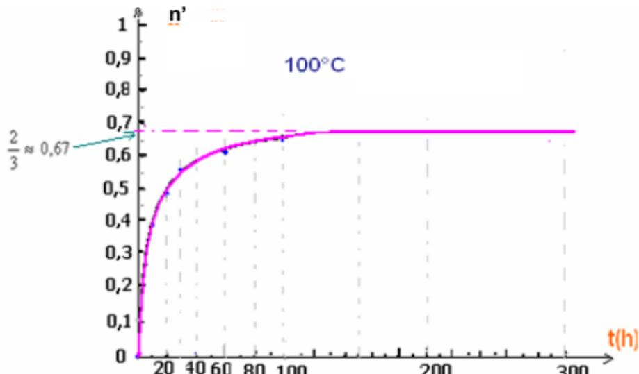
Pour obtenir un mélange de composition constante à  $100^\circ\text{C}$  , on a besoin de 150heures , donc la réaction d'estérification est une réaction **lente**
