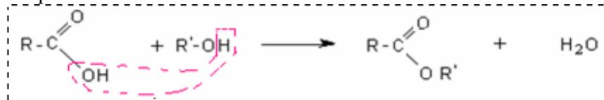
Dans une réaction d'estérification la molécule d'acide perd le groupement -OH et celle d'alcool perd le groupement -H pour conduire à un ester et une molécule d'eau.
