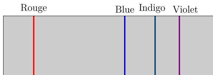
La lumière d'hydrogène produit un spectre de raies, cet spectre contient 4 raies de longueur d'onde différente. L'énergie d'hydrogène ne peut donc prendre que des valeurs discrètes proportionnelle à la longueur d'onde des raies produits.
