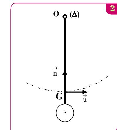
On relie l'une des extrémités du ressort spiral à l'extrémité O de la tige et on fixe l'autre extrémité du ressort à un support fixe de telle façon que le ressort spiral soit non déformé lorsque le pendule pesant est dans sa position d'équilibre stable (figure3).
