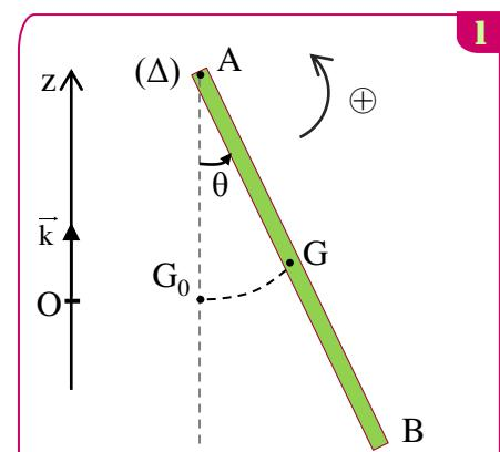
1-2- Déterminer la nature du mouvement du pendule pesant et écrire l'équation horaire  $\theta(t)$  en fonction de  $t$ ,  $\theta_m$  et la période propre  $T_o$ .
