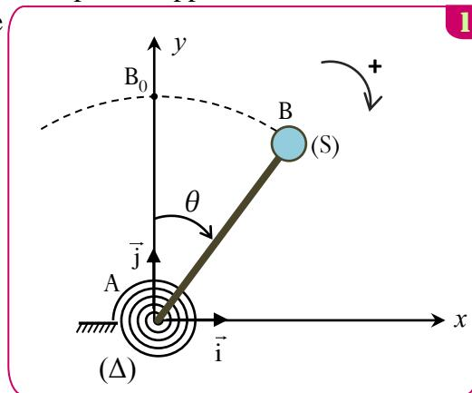
On écarte le système mécanique de sa position d'équilibre vertical d'un angle petit  $\theta_{\max}$  dans le sens positif puis on le lâche sans vitesse initiale à un instant  $t=0$ .
