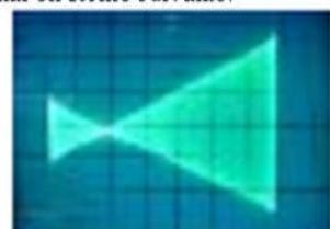
Quand la modulation est mauvaise qualité, l'enveloppe du signal modulé n'est pas identique au signal modulant. Cela est dû au fait que le décalage en tension  $U_o$  est inférieur à l'amplitude  $S_m$  du signal modulant,  $m = \frac{S_m}{U_o} > 1$  soit  $U_o < S_m$  on dit qu'il y'a surmodulation.
