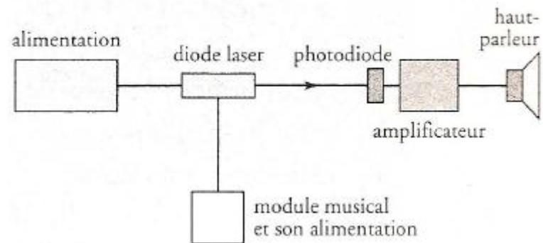
Dans le cas de cette transmission, l'information sonore est véhiculée par une onde lumineuse (porteuse), modulée par le signal à transmettre.
