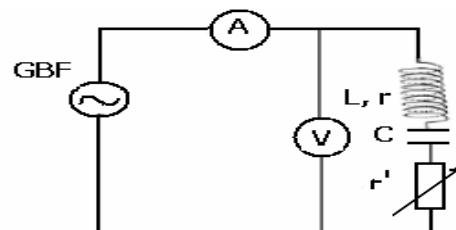
On mesure la variation de l'intensité efficace dans le circuit avec la variation de la fréquence puis on change la valeur de la résistance totale du circuit.
