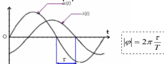
Si  $u(t)$  est avance de phase par rapport à  $i$   $\varphi > 0$  et si  $u(t)$  est retard de phase par rapport à  $i$   $\varphi < 0$ .
