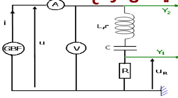
On visualise sur l'écran de l'oscilloscope dans l'entrée  $Y_2$  la tension  $u(t)$  entre les bornes de RLC et dans l'entrée  $Y_1$  la tension  $u_R(t)$  aux bornes du conducteur ohmique .On obtient l'oscilloscopogramme de la figure suivante:
