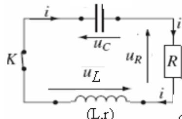
En appliquant la loi d'additivité des tensions on a:  $u_R + u_L + u_C = 0$
