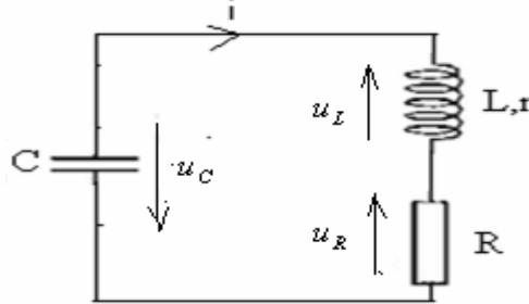
En appliquant la loi d'additivité des tensions on a:  $u_R + u_L + u_C = 0 \Rightarrow R.i + r.i + L \cdot \frac{di}{dt} + u_c = 0$  d'où:
