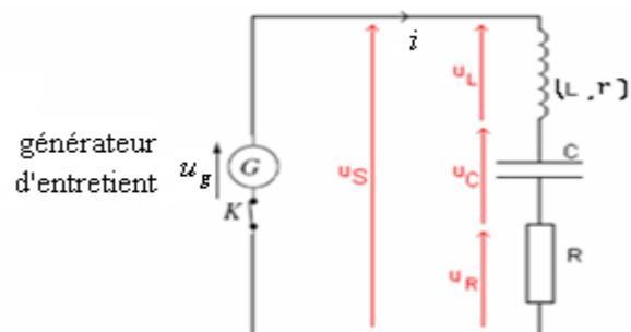
La tension aux bornes du générateur d'entretien est proportionnelle à l'intensité du courant  $u_g = R_o i$  avec:  $R_o = R + r$
