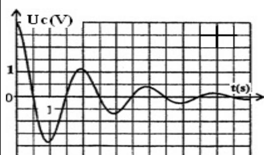
L'amplitude des oscillations diminue au cours du temps
