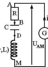
Si  $U_{AM} = (R+r) \cdot i$  La tension au borne du générateur est proportionnelle à l'intensité de courant et que le coefficient de proportionnalité est  $(R+r)$  alors  $\ddot{q} + \frac{1}{LC} \cdot q = 0$
