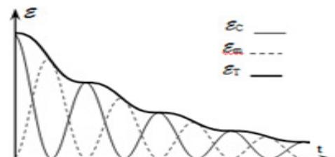
• Les oscillations correspondent à un échange énergétique entre le condensateur et la bobine : Il y a conversion d'énergie électrique en énergie magnétique et réciproquement.
