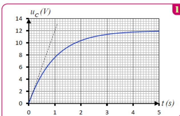
pour vérifier la capacité C on décharge le condensateur et on l'enlève du caméra puis on le monte en série avec un générateur idéale de tension  $E=12V$  et un conducteur ohmique de résistance  $R=10K\Omega$  et un interrupteur k. à l'instant  $t=0$  on ferme l'interrupteur et on suit les variations de tension  $u_C$  appliquées aux bornes du condensateur et on obtient la courbe  $u_C=f(t)$ .
