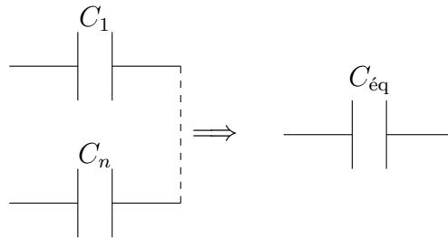
Puisque le montage est en parallèle alors :  $u = u_1 = \dots = u_n$  et  $i = i_1 + \dots + i_n \iff q = q_1 + \dots + q_n$ .
