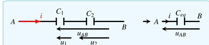
La capacité équivalente C du condensateur équivalent de l'association en série de deux condensateurs de capacités  $C_1$  et  $C_2$  est telle que
