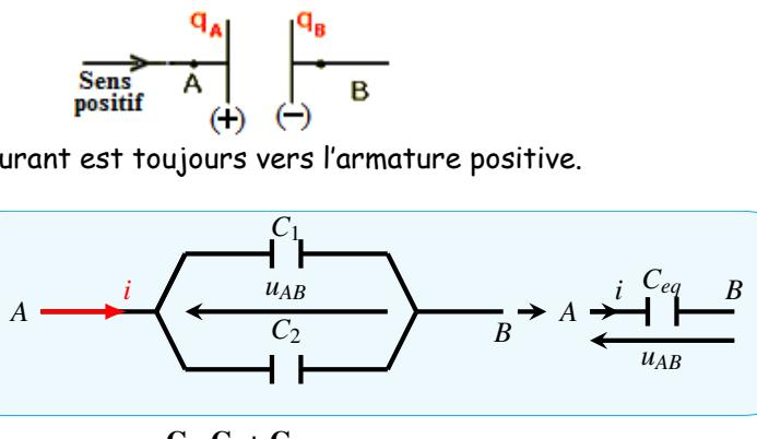
La capacité équivalente C du condensateur équivalent de l'association en parallèle de deux condensateurs est égale à la somme de leurs capacités C<sub>1</sub> et C<sub>2</sub>.
