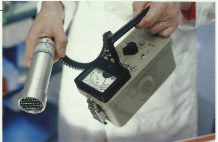
Doc. 1 Le compteur Geiger permet de détecter les sources radioactives grâce au rayonnement émis.
