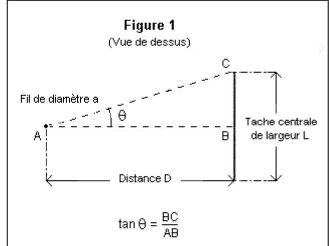
$$\theta = \frac{\lambda}{a} \quad (\theta \text{ en radian}, \lambda \text{ et } a \text{ sont en mètre})$$
