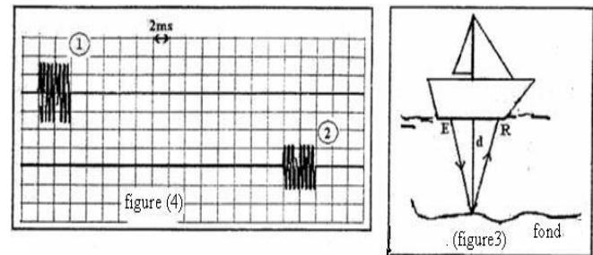
Dans la figure (4) qui a été visualisée par un appareil convenable, le signal (1) est celui émis par l'émetteur **E** , le signal (2) représente celui reçu par le récepteur **R**.
