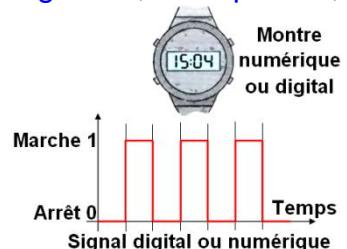
Les automates programmables et tous les systèmes à microprocesseurs ne manipulent que ces deux grandeurs matérialisées par des signaux électriques :
