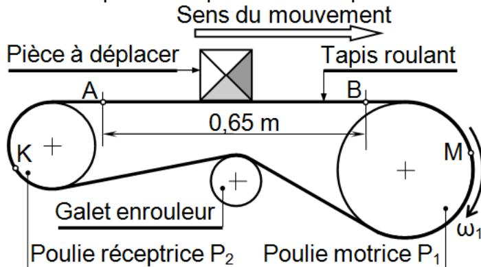
La poulie motrice  $P_1$ , tournant à 1500 tr/min, fait dérouler le tapis et entraîne la pièce dans un mouvement de translation de vitesse  $V(t)$ .
