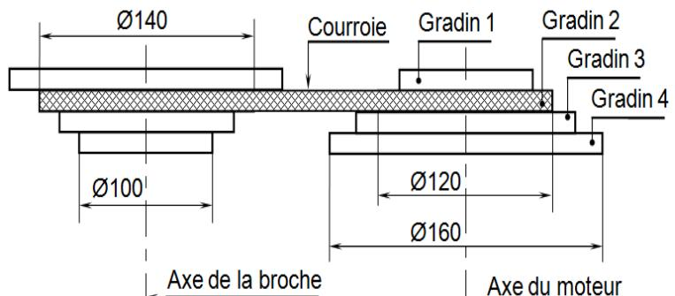
Le moteur commande la rotation de la broche de perceuse à l'aide du système poulies étagées avec courroie. Les 2 poulies étagées sont identiques et leur sens de montage sur l'axe du moteur et l'axe de la broche est inversé. Le réglage de la vitesse de rotation de la broche se fait en plaçant la courroie sur le gradin souhaité. On obtient ainsi quatre rapports de transmission :  $r_1$ ,  $r_2$ ,  $r_3$  et  $r_4$  avec  $r = N_{\text{Broche}} / N_{\text{Moteur}}$ .
