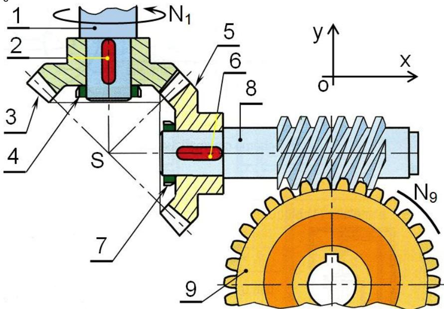
**1- Quelle est** le sens d'hélice de la vis sans fin 8 (drite ou gauche).
