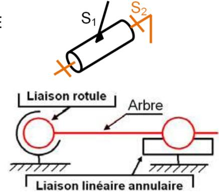
↳ **Remarque :** - La liaison pivot (entre S<sub>1</sub> et S<sub>2</sub>) c'est l'équivalent de la liaison rotule + liaison linéaire annulaire.
