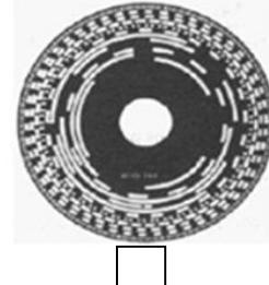
Q.22. Confirmation ou négation quant au pouvoir du codeur de résolution  $R = 500$  impulsions/tour à mesurer la position de la table avec la précision p est de 0,01 mm.
