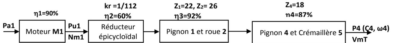
**Pa1** : Puissance absorbée par le moteur **M1**.
