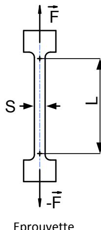
Le diagramme de traction obtenu représente l'évolution de la charge unitaire  $R$  en fonction du taux d'allongement  $e = \Delta L / L_0$
