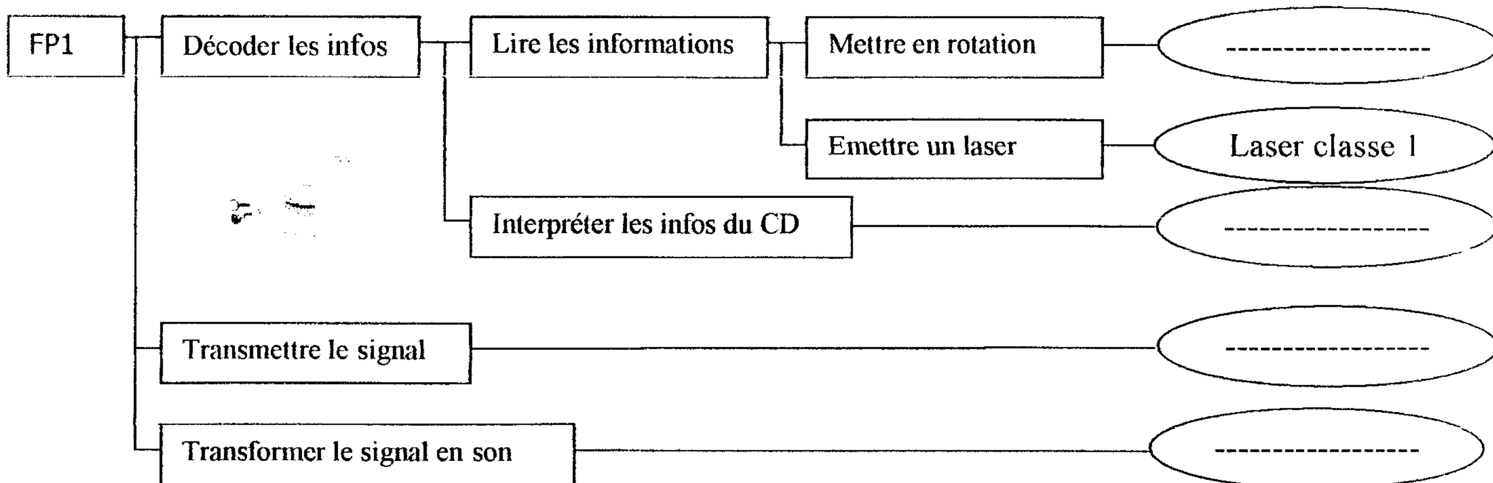
5°) Diagramme FAST de la fonction technique : Installer un CD. (...../2,5pts)
