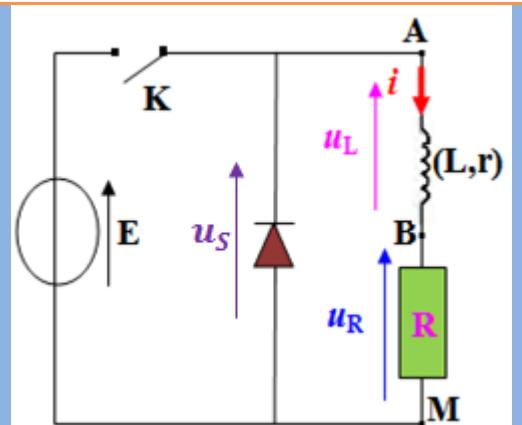
عند فتح الدارة ينتج فرط توتر في الدارة ، وتظهر معه شرارة كهربائية على مستوى قاطع التيار لتبقى شدة التيار متصلة ، وقد يؤدي إلى إتلاف بعض أجزاء الدارة . ولتفادي ذلك ، نضيف للدارة صماما ذي وصلة نسميه في هذا التركيب "صمام العجلة الحرة " .
