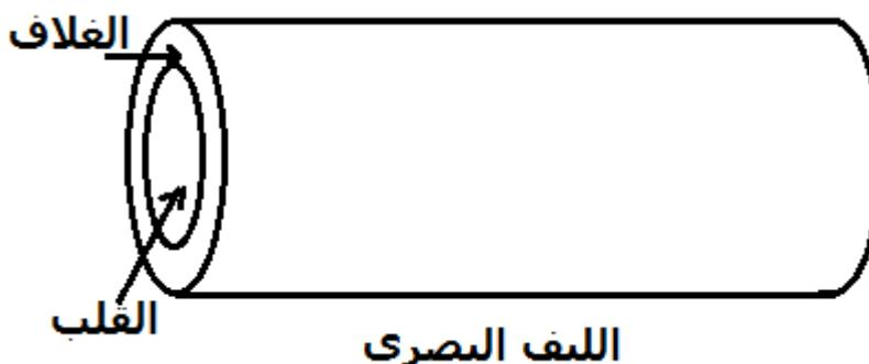
نعتبر ليف بصري طوله  $L = 0,0$  ي تكون من قلب شعاعه  $Ox$  ، معامل انكساره  $n_0$  وغلاف معامل انكساره  $n_1 > n_0$  حيث  $n_1 = 1,50$  ، معامل انكسار الهواء  $n_0 = 1,00$  وسرعة انتشار الضوء في الهواء  $c = 3 \times 10^8 \text{ m/s}$  . (أنظر الشكل)
