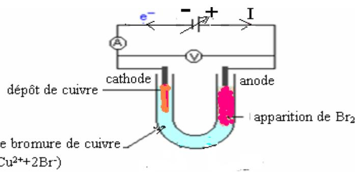
Pour une tension supérieure à 1,2V on constate la formation d'un dépôt de cuivre sur la cathode et formation du dibrome  $\text{Br}_2$  au voisinage de l'anode.
