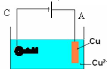
On obtient un dépôt de cuivre sur la clef. et on constate la diminution de l'anode. C'est une électrolyse à anode soluble.
