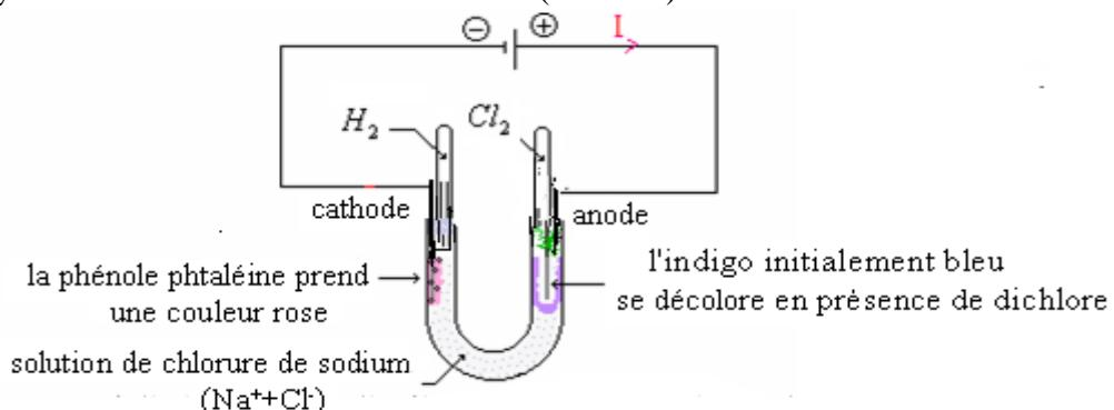
L'expérience montre qu'il y'a dégagement du dichlore  $\text{Cl}_2$  au voisinage de l'anode et dégagement du dihydrogène  $\text{H}_2$  et formation des ions hydroxydes  $\text{HO}^-$  au voisinage de la cathode.
