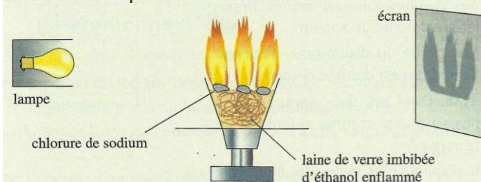
Avec une lampe à incandescence, l'écran est uniformément éclairé. En utilisant la lampe à vapeur de sodium, on observe, sur l'écran, l'ombre de la flamme (voir schéma ci-dessus).
