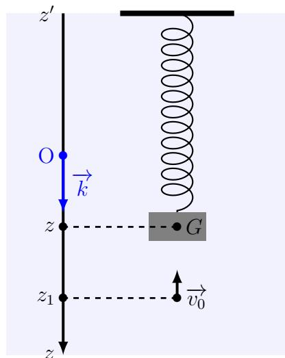
1. Montrer que le mouvement du centre d'inertie  $G$  du solide obéit, en absence de frottement, à l'équation différentielle suivante :
