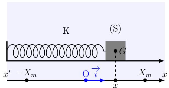
On considère un axe  $(O, \vec{i})$ , avec O coïncide avec la position du centre d'inertie G du solide à l'équilibre et le vecteur unitaire  $\vec{i}$  parallèle au déplacement du solide. On repère la position G du solide à chaque instant par l'elongation  $OG = x(t)$ .
