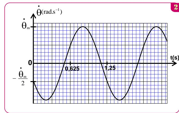
2 La solution de cette équation différentielle s'écrit sous la forme :  $\theta(t) = \theta_m \cos\left(\frac{2\pi}{T_0}t + \varphi\right)$  où  $T_0$  est la période propre du pendule.
