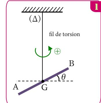
0. En appliquant la relation fondamentale de la dynamique dans le cas de la rotation autour d'un axe fixe, déterminer que l'équation différentielle du mouvement du système étudié.
