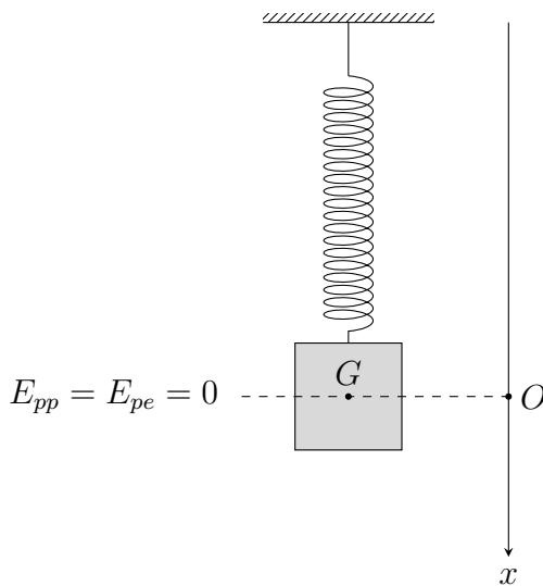
**Énergie potentielle :** On considère que lorsque le système est en équilibre  $E_{pe} = 0$ , ainsi que le plan passant par  $G$  à l'équilibre, constitue l'état référentiel de l'énergie potentielle de pesanteur  $E_{pp} = 0$  :
