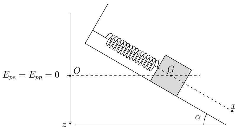
**Énergie potentielle :** On considère que l'énergie potentielle élastique est nulle  $E_{pe} = 0$  lorsque le système est en équilibre, ainsi que le plan passant par  $G$  constitue à l'équilibre l'état référentiel de l'énergie potentielle de pesanteur  $E_{pp} = 0$  : On sait que :
