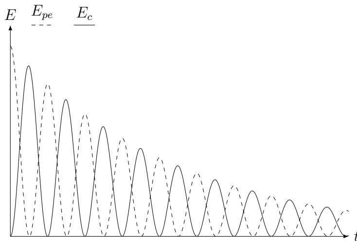
L'énergie mécanique se transforme progressivement en chaleur, et le mouvement continue jusqu'à que le système revient à sa position d'équilibre. Sa dérivée est donc négative vaut le travail des forces de frottements.
