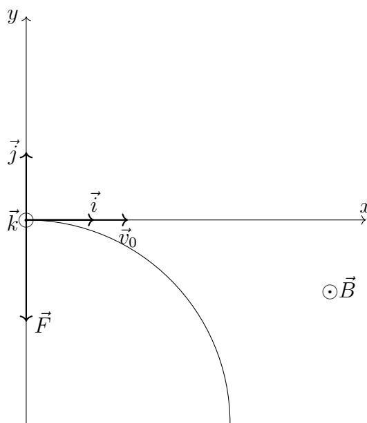
Le mouvement de la particule dans le champ  $\vec{B}$  est uniforme et circulaire, qui se fait dans un plan.
