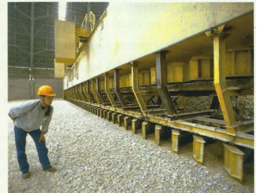
Doc. 14 De nombreuses réactions industrielles font intervenir des réactifs solides : avant tout traitement chimique, le solide est concassé et broyé afin d'offrir aux réactifs une surface d'attaque maximale.
