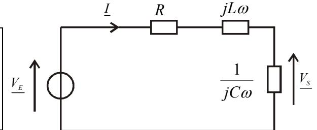
Pour identifier les équations (1) et (2), il faut transformer l'équation 1 pour faire apparaître le terme  $1 + j(\dots)$ . On multiplie par  $jC\omega$  au numérateur et au dénominateur :
