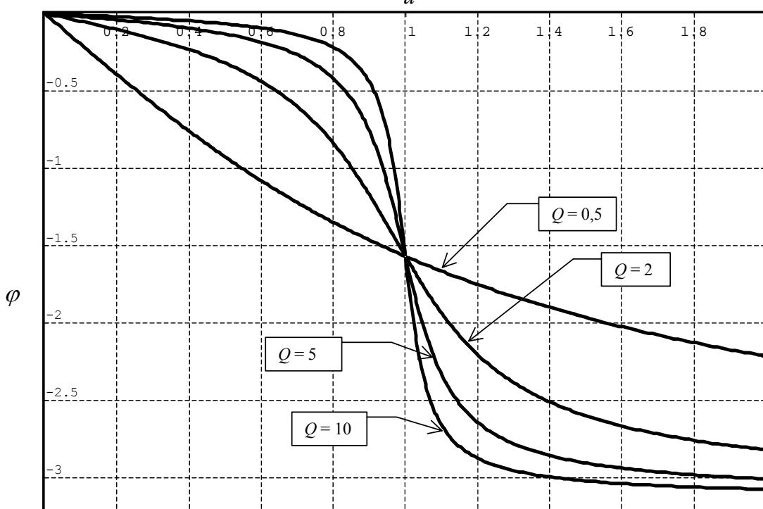
On a toujours  $\varphi < 0$ , la tension de sortie est donc toujours en retard de phase par rapport à la tension d'entrée.
