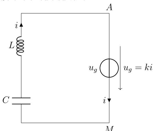
Aux bornes ( $A, M$ ) d'un circuit (rLC) plaçons un générateur fournissant à ses bornes une tension proportionnelle au courant qu'il délivre :
