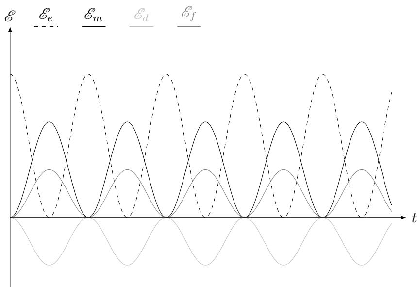
$\mathcal{E}_e$  signifie l'énergie du condensateur (électrique),  $\mathcal{E}_m$  l'énergie de la bobine (magnétique),  $\mathcal{E}_d$  l'énergie dissipée dans la bobine et  $\mathcal{E}_f$  l'énergie fournie par le dispositif d'entretien.
