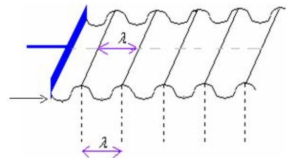
La coupe de la surface de l'eau montre que l'onde rectiligne à la surface de l'eau est aussi transversale.
