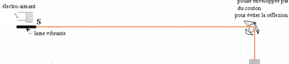
Lorsque la lame vibre avec une fréquence  $v = 100\text{Hz}$  , la corde paraît floue, ce qui prouve que tous ses points sont en mouvement.
