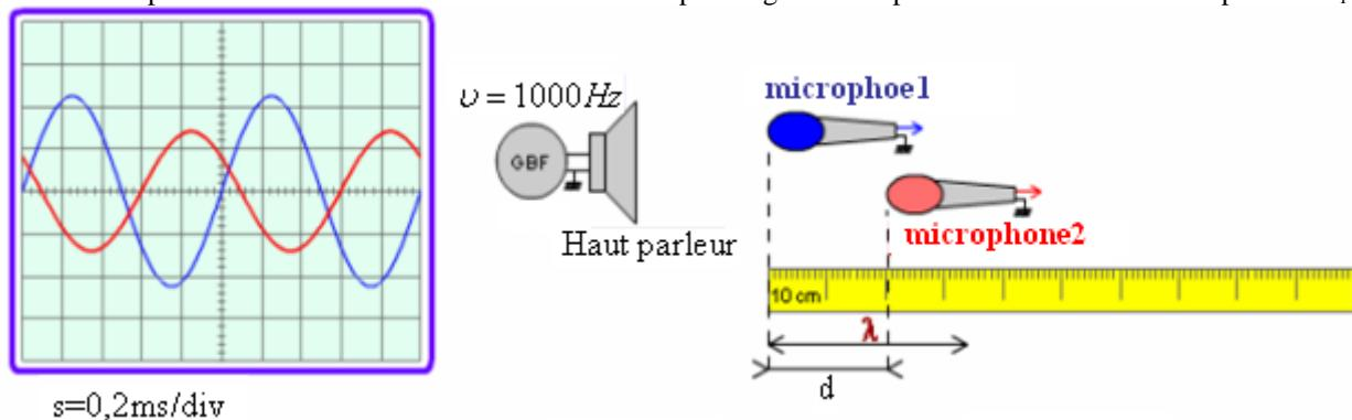
Lorsque les deux microphones sont placés côté à côté face au haut parleur et à la même distance de lui, les deux signaux correspondant à  $M_1$  et à  $M_2$  sont en phase.
