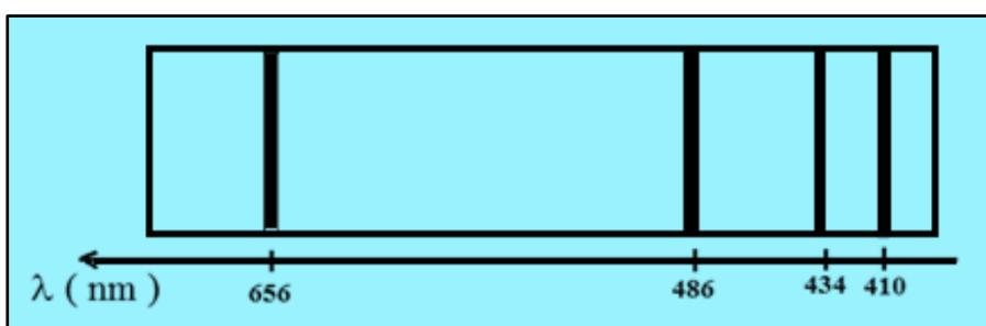
نلاحظ وجود حزات سوداء محل الحزات الملونة لحزاة الانبعاث . هذه الحزات توافق الاشعاعات الممتصة والتي لها نفس طول الموجة للأشعاعات المنبعثة من طرف مصباح الهيدروجين . نفس هذا يكون أن مختلف طاقة فوتونات الضوء الأبيض ، فقط الفوتونات التي لها طاقة توافق الفرق الموجود بين مستويين طاقيين للذرة هي التي تمتص .
