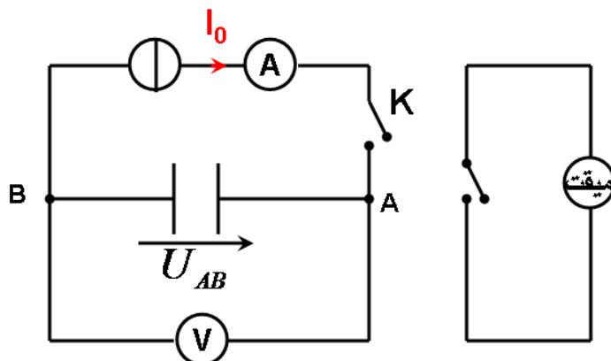
عند غلق قاطع التيار  $K$  يزود المولد الدارة بتيار شدته  $I_0$  ثابتة وفي نفس الوقت ينطلق الميقت و يبدأ بحساب المدة الزمنية اللازمة لظهور التوتر  $u_{AB}$  ، نقىس هذا الأخير بالنسبة لكل مدة زمنية  $t$  و ندون النتائج التالية و نخط  $u_{AB} = f(t)$
