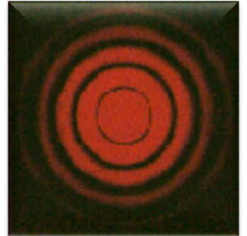
شكل الحيود الملاحظ على الشاشة باستعمال ثقب : البقعة الضوئية المركزية دائرية عرضها أكبر من الحزمة الواردة ، محاطة ببعض الحلقات الأقل إضاءة
