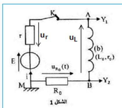
$$\tau \cdot \frac{di}{dt} + i = I \left\{ \begin{array}{l} I = \frac{E}{R_0 + r_0 + r} \\ \tau = \frac{L_0}{R_0 + r_0 + r} \end{array} \right. \quad \begin{array}{l} \text{شدة التيار في النظام الدائم} \\ \text{ثابتة الزمن} \end{array}$$
