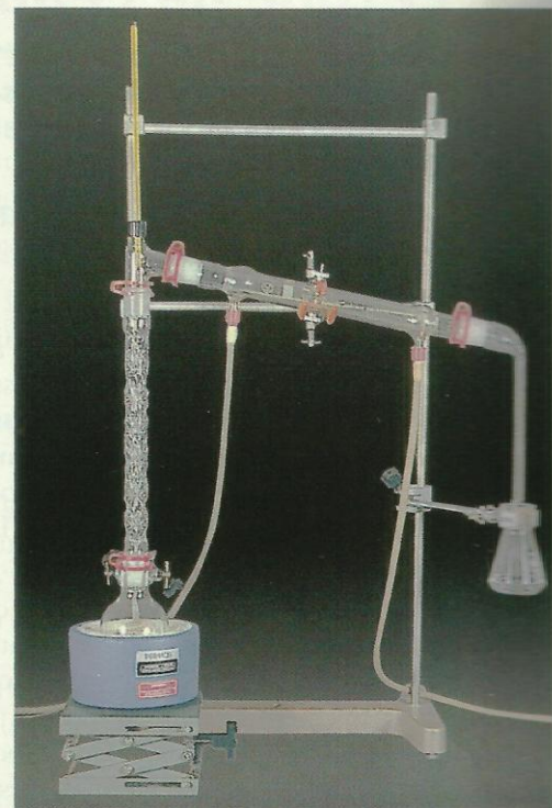
Doc. 11 En distillant le méthanoate d'éthyle ( \theta_{eb} = 54^\circ\text{C} ) au fur et à mesure de sa formation par réaction de l'acide méthanoïque ( \theta_{eb} = 101^\circ\text{C} ) avec l'éthanol ( \theta_{eb} = 78^\circ\text{C} ), on améliore le rendement de la synthèse de cet ester à odeur de rhum.
