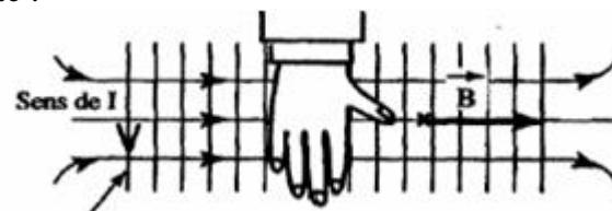
L'expérience montre que l'intensité du champ magnétique à l'intérieur du solénoïde est proportionnelle à l'intensité du courant électrique qui le traverse et au nombre de spires par unité de longueur.
